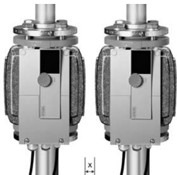
Vereinfachte Darstellung, Einbaumaße zusätzlicher Armaturen berücksichtigen.
